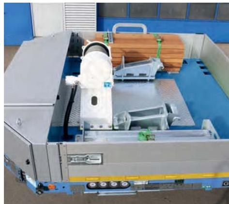
Verstauhilfen für Rungen und Verbreiterbohlen, Seilwinde
