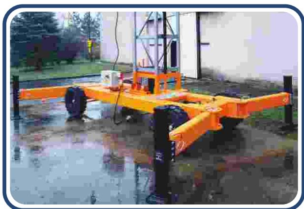
Las plataformas del tipo WP se usan particularmente en la industria de la construcción para montajes, dar mantenimiento a equipos y fachadas, hacer trabajos de acabado de concreto, pintar estructuras y otros trabajos similares. Se puede mudar de sitio en sitio dentro de la obra en su propio bastidor. Los modelos de 2 y 3 toneladas disponen además de la soldadura trasera, movida.
