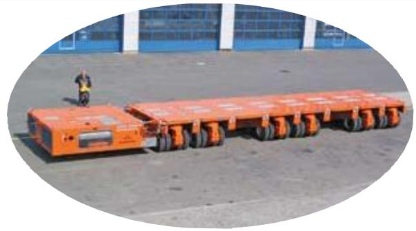
Auch für die selbstfahrenden Schwerlastmodule steht neben Power Packs mit unterschiedlicher Motorleistung eine umfangreiche Zubehörpalette wie z. B. Fahrerkabinen, Front- und Schlußbeleuchtung, etc. zur Verfügung. Über die optional verfügbare funkferngesteuerte Remote Control lassen sich diese Fahrzeuge kabellos steuern, so dass sich der Bediener direkt am Ort des Geschehens aufhalten kann. Die von Goldhofer entwickelte HYDRONIC dient zur Lenksynchronisation von mechanisch gelenkten Modulen.
