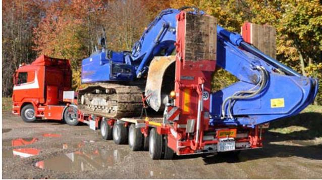
Nachlaufgelenkte Goldhofer Sattelieflader der Typenreihe STN werden bevorzugt in der Transportlogistik sowie in der Baubranche eingesetzt. Sie sind eine kostengünstige Alternative zu den zwangsgelenkten Fahrzeugen. Die nachlaufgelenkten Sattelanhänger sind als 2- bis 5-Achser lieferbar. Je nach Anzahl der Achsen werden eine bis drei Achsen gelenkt, die übrigen Achsen sind un gelenkt. Der Nutzlastbereich liegt je nach Ländervorschrift und Achszahl bei bis zu 60 t.
